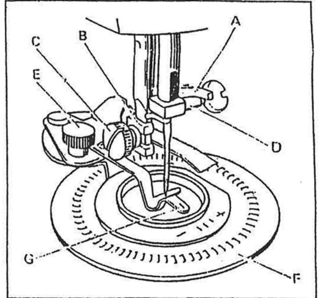
**NOTE vous pouvez utiliser ce pied avec une aiguille double et deux fils de différentes couleurs. Dans ce cas ne réglez jamais la largeur à plus de 2.**
